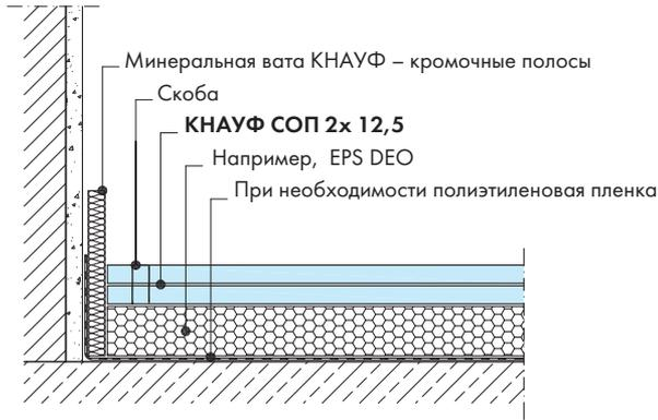
F145-V10 Примыкание к стене, перекрытие из деревянных балок
