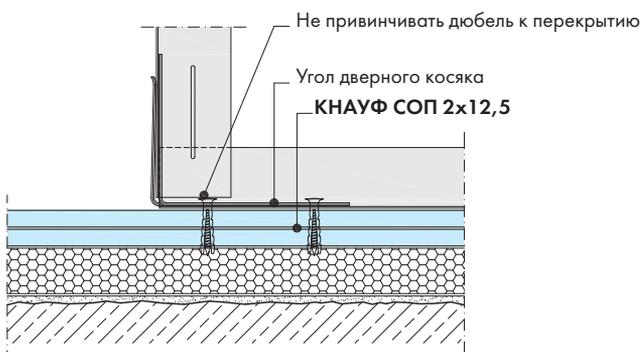
F145-V6 Стык плит под дверным проемом
